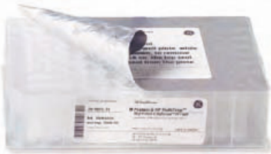
图 3.6 Protein G HP MultiTrap 96-well plates可以被用来少量同时筛选或者纯化多个单克隆或多克隆样品
