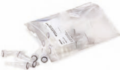
图 3.16 Protein A HP SpinTrap columns是连有A蛋白配体的分离纯化柱，它能够用于小规模筛选目标抗体
