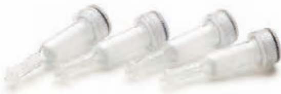
图 2.8 PD SpinTrap G-25柱是为各种生物分子脱盐和更换缓冲液的一次性使用柱，它的分离极限为5000
