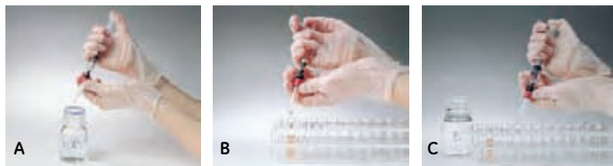
图A4.1 将HiTrap柱同注射器一起使用。(A) 准备样品和缓冲液。除去柱子的顶盖并拧去末端堵头。(B) 平衡柱子，上样并收集样品。(C) 冲洗和洗脱，继续收集样品。
