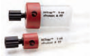
图 3.20 HiTrap rProtein A FF columns是预装有rProtein A Sepharose Fast Flow的分离纯化柱, 它对单克隆抗体具有很高的结合容量
