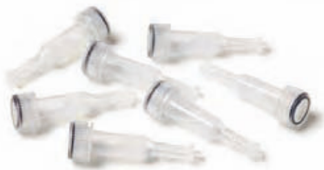
图 3.9 Protein G HP SpinTrap columns适用于蛋白的富集，它利用G蛋白对抗体的亲和力，其适合于实验室中小规模的纯化操作
