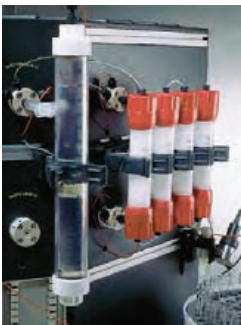
图2.6 使用4根串联的HiPrep 26/10 Desalting柱能够将上样体积增大到60ml
