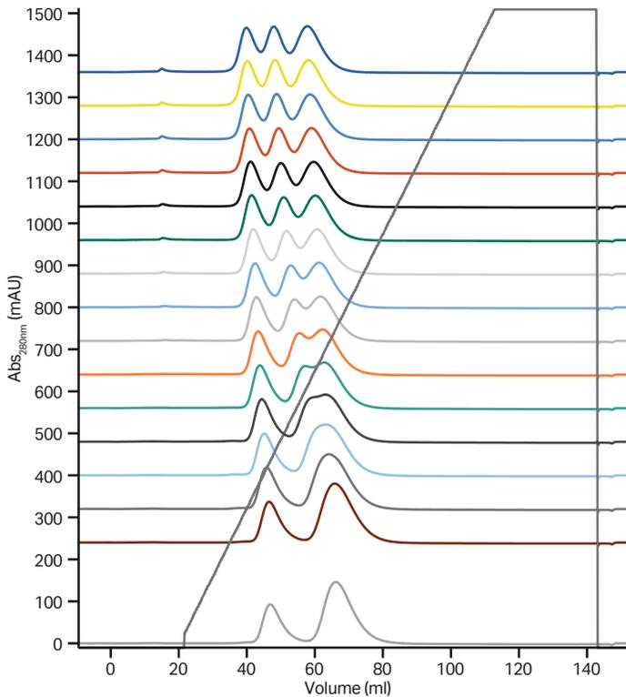
图 8. 使用 HiScreen™ Capto™ S 层析柱和 pH 值为 4.0 到 5.5 范围内的 CIE X 缓冲液运行实验。层析图谱显示使用小的 (0.1) pH 变化量的十六次运行。CIE X 缓冲液的整体缓冲范围是 2 到 7。
