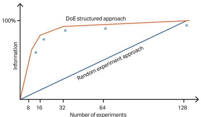
图 9. UNICORN 中的 **DoE** 工具是一种高效的优化方法，可以在较少的实验中获取更多的信息。
